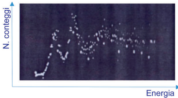
Fig. 2. Spettro di energia dei raggi \gamma emessi dalla sorgente radioattiva di ^{60}\text{Co} così come ottenuti dall'analizzatore multicanale di Fig. 1 senza l'attivazione della circuiteria elettronica corrispondente all'idea del righello scorrevole.
