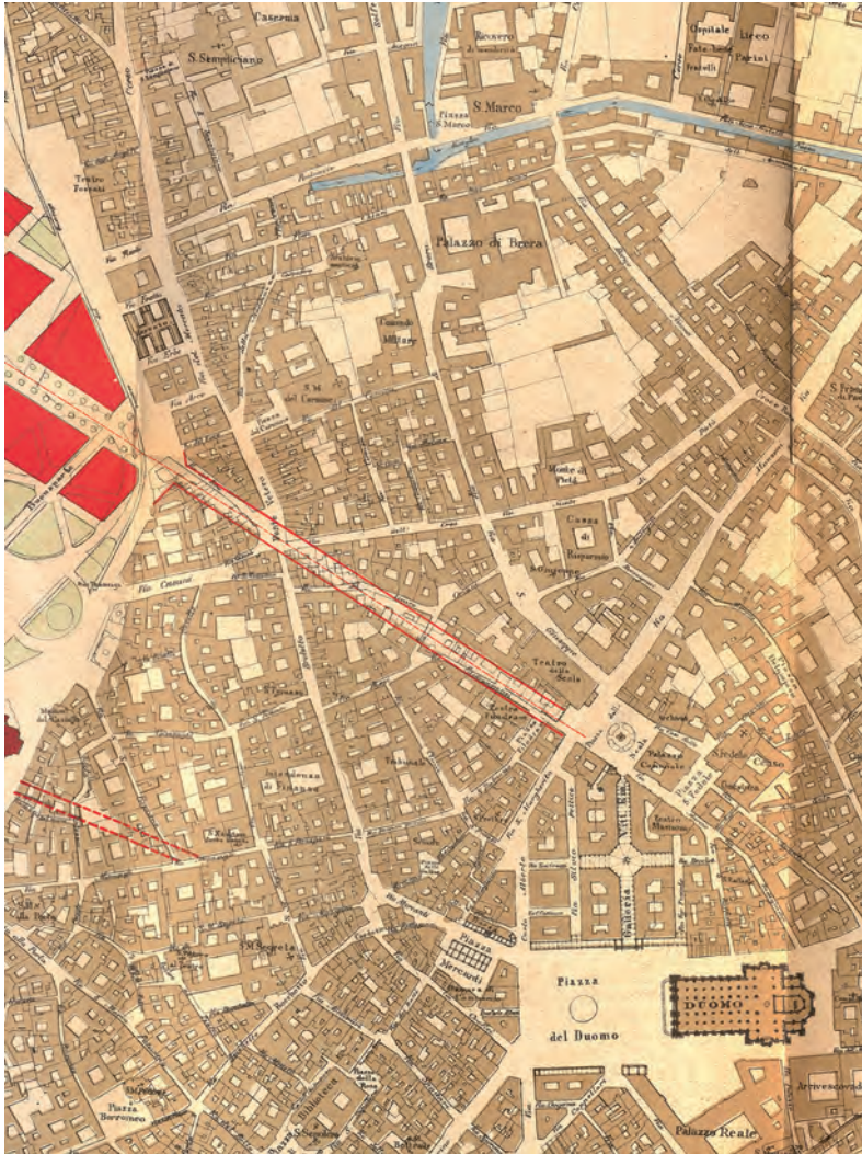
Fig. 14. Il progetto di Luigi Broggi con i due assi stradali che iniziano all'arco della Pace, passano a lato del Castello; quello a nord-est giunge in piazza della Scala, quello a sud-est al Teatro dal Verme, si inoltra nella città storica per un breve tratto fino a via Meravigli. Da: Luigi Broggi, Progetto di un nuovo quartiere per casoggiati e villini e della sua congiunzione col centro della città contrapposto a quello dell'ing. Maraini , Bernardoni, Milano 1880, tavola fuori formato, particolare (Biblioteca Nazionale Braidense, MISC. 0573/43 - aut. MIC_PIN-BR_UO13/12/2024/0001580-P, © Su concessione del Ministero della Cultura - Pinacoteca di Brera - Biblioteca Braidense, Milano - divieto di ulteriore riproduzione o duplicazione con qualsiasi mezzo).
