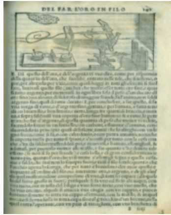
Fig. 7 – Dispositivo per produrre fili d'oro a partire dal massello.
