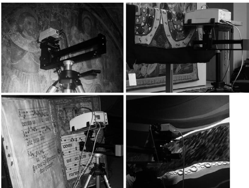
Fig. 1. Esempi di assetto strumentale per misure spettroscopiche FTIR, Raman, di riflettanza nel visibile e di fluorescenza ottica durante analisi in campo su diverse tipologie di manufatti artistici.
