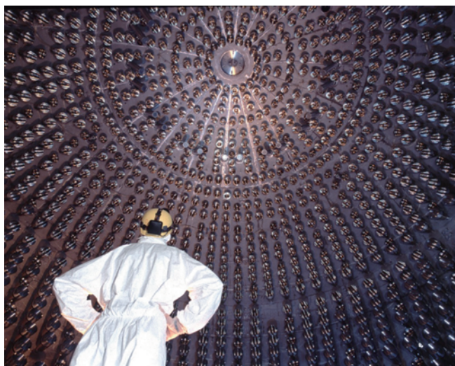
Fig. 1. L'interno della sfera di Borexino prima del suo riempimento. Si vedono buona parte dei tubi fotomoltiplicatori che rivelano la luce emessa dall'interazione dei neutrini.
