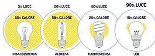
Fig. 11. Confronto tra luce emessa e calore dissipato delle diverse fonti luminose.
