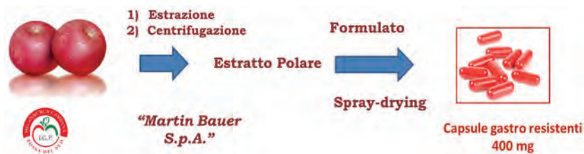
Fig. 7. Processo industriale per la produzione di capsule gastro resistenti di estratti di mela annurca.
